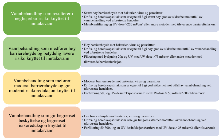
Figur E.2: Vannbehandling har stor betydning for risikoreduksjon knyttet til inntaksvann. Det er redegjort skjematisk for typisk vannbehandling basert på UV i figur E.2 («En oversikt over vannbehandling med ulik barrierehøyde», Åkerblå mars 2022)
