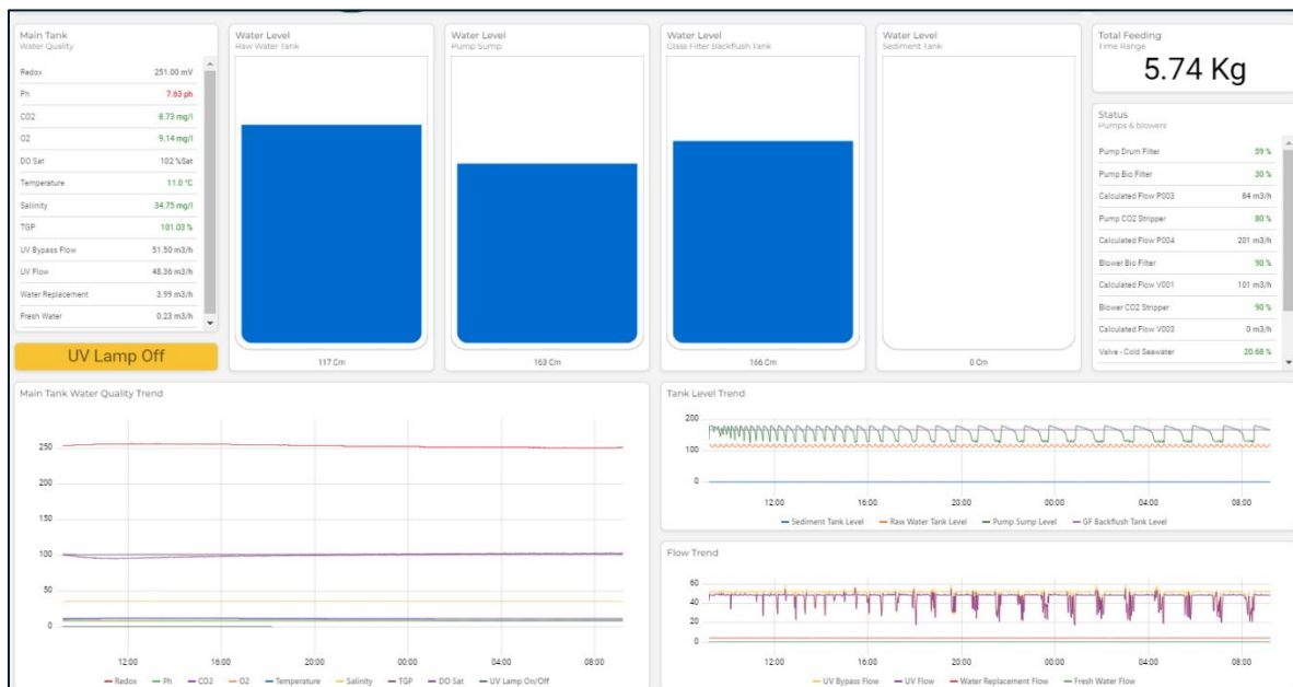
Bilde 1: Live overvåking av anleggets vannkvalitetsparametere, vannivå og kritiske komponenter. Systemet er tilgjengelig for alle ansatte via mobil-app og gir alarmer ved overskridelser av grenseverdier.
